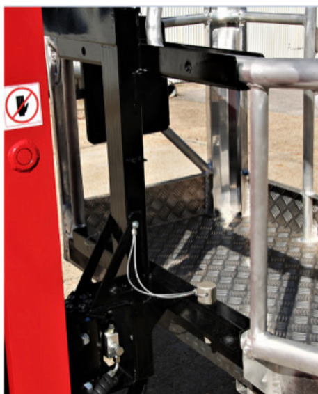
SIKKERHETSPINS Med fjærforsikring
