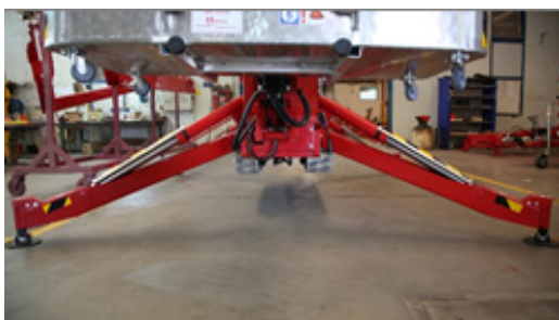
14/1. Fig. Gummisporunderstell i smal posisjon
