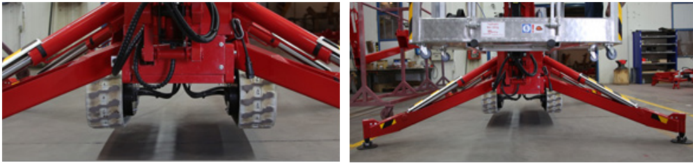
14/2. Fig. Gummisporunderstell i smal posisjon
