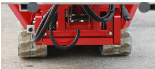
14/1. Fig. Gummisporunderstell i smal posisjon
