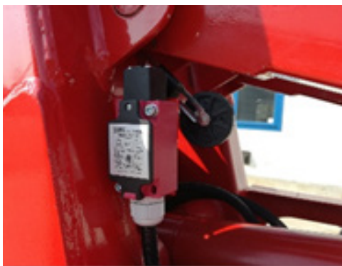
Figur 23 Begrensningsbryter for nedre arm
