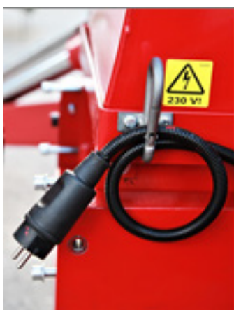
10/2. Fig. Tilkoblingsplugg 230 V / 16 A.
